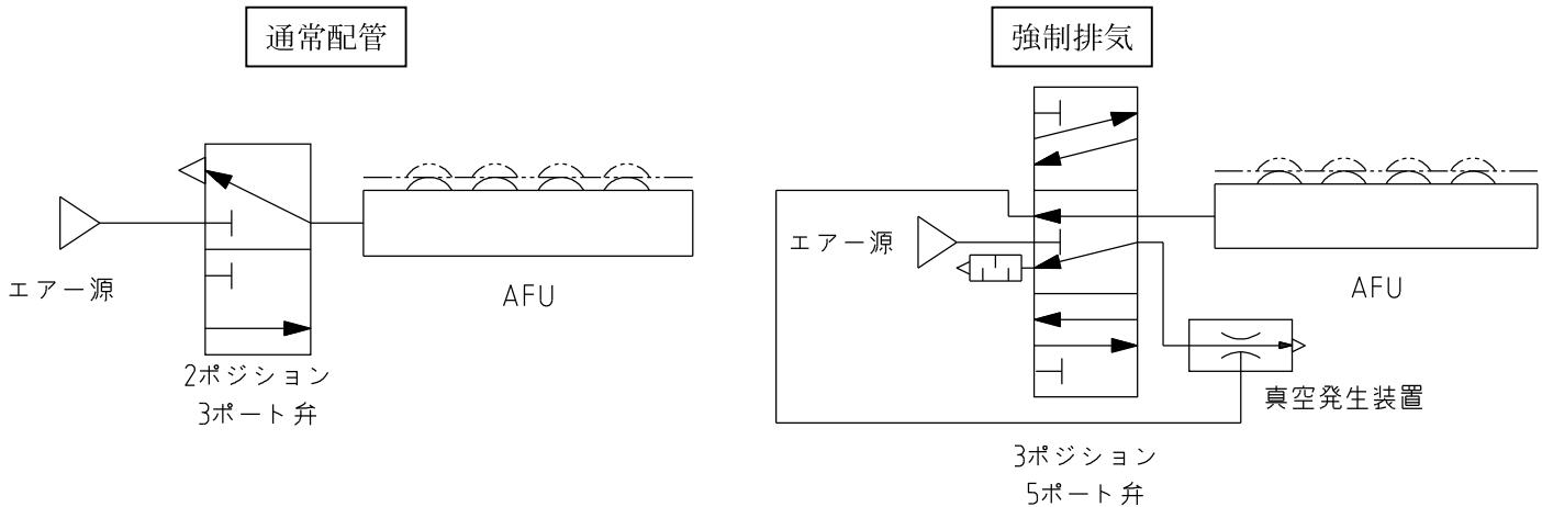
※本製品のフリーべア部は、下降動作時、エアー排気してもシリンダーのOリングの抵抗等により自然に下降しません。(残圧は抜けているため、搬送物の自重等の負荷により下降します。)フリーべアを強制的に下降させる場合は、「強制排気」回路を参照してください。
