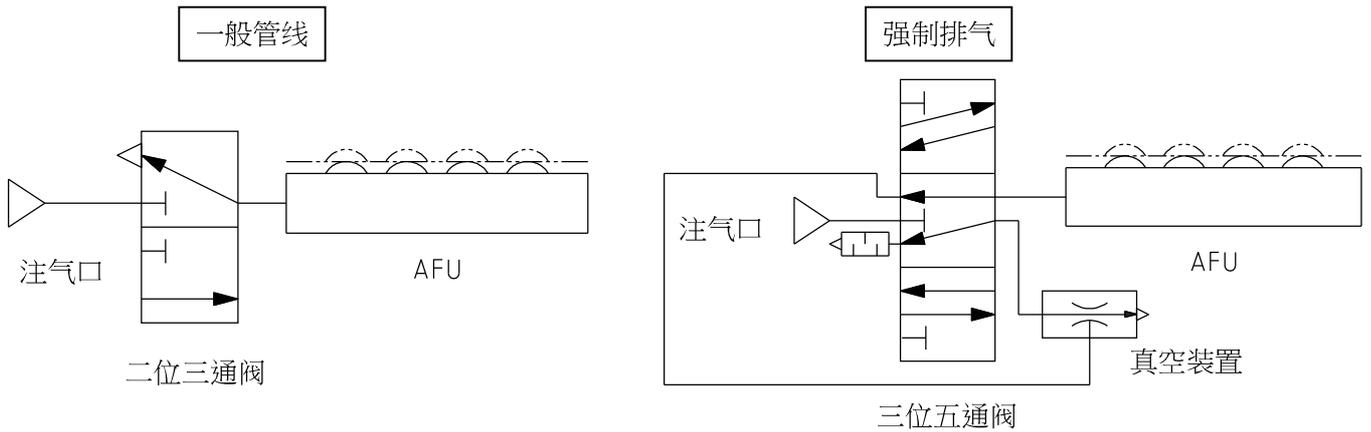
※本产品的 **Freebear** 在下降动作时，即使排放空气，由于气缸的 O 型环等的阻力，并不会自然下降。（因为残压已经排出，因此会在搬运物的自重等负荷下下降）若要强制使 **Freebear** 下降，请参照「强制排气」回路。
