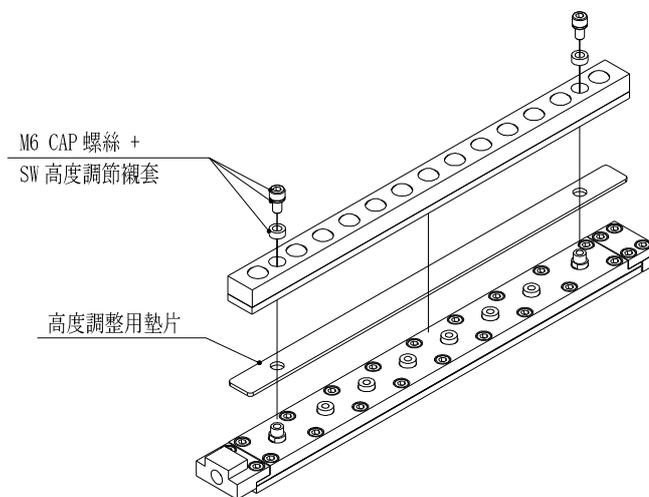
根據墊片（厚度和數量）調整高度
